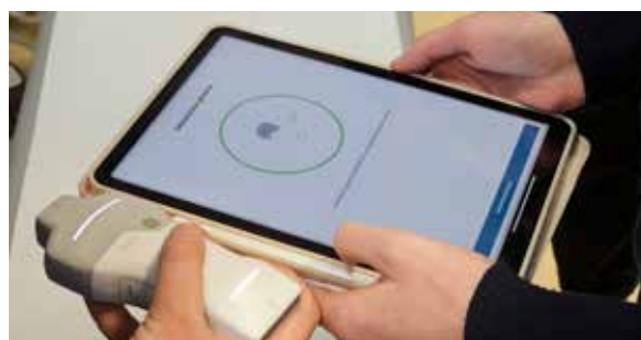
Ustawienie połączenia aparatu Vscan z tabletem za pomocą technologii Bluetooth
