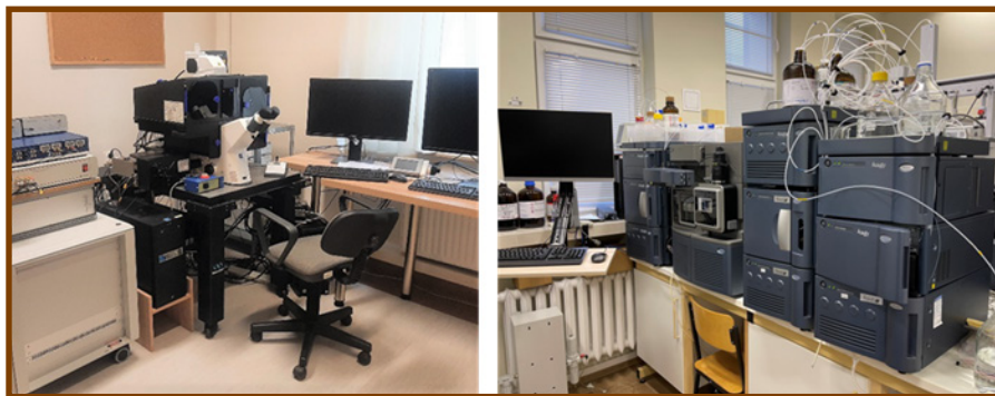
Wybrana aparatura badawcza z Katedry Biofizyki (odwrócony mikroskop fluorescencyjny - SIM) oraz z Katedry Biochemii Klinicznej (wysokosprawny chromatograf ciekły z detektorem masowym)
