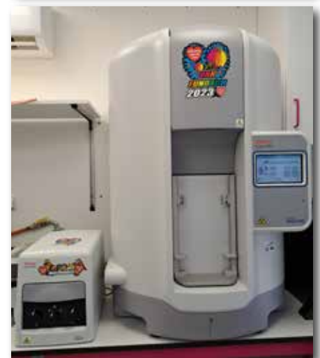
System ThermoScientific Sensititre Aris HiQ (Argenta) do oceny najmniejszych stężeń antybiotyków hamujących wzrost bakterii. Uwzględnia również nowe antybiotyki
