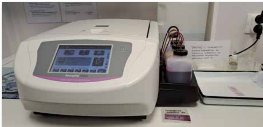
Aparat Genie II (Argenta) wraz z oprogramowaniem umożliwia wykonywanie amplifikacji izotermicznej (LAMP) z wykrywaniem docelowego kwasu nukleinowego w czasie rzeczywistym. W połączeniu z zestawami eazyplex (AmplexDiagnostics GmbH) przeznaczonymi jest m.in. do wykrywania bakterii atypowych, grzybów Pneumocystis jiroveci i genów odpowiedzialnych za oporność na antybiotyki. Jeden z testów służy do wykrywania karbapenemaz (KPC, VIM, NDM, OXA-48, OXA-23, OXA-40, OXA-58) w ciągu 15 minut. Aparat dzierżawiony
