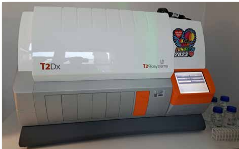
System T2Dx (Biomedica) oparty o technologię rezonansu magnetycznego wykrywa bezpośrednio w próbce krwi najczęstsze patogeny zakażeń krwi i wybrane geny oporności na antybiotyki
