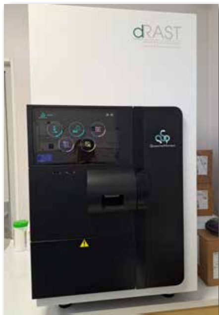
dRAST (Argenta) – aparat zapewnia ocenę wartości najmniejszych stężeń antybiotyków hamujących wzrost bakterii bezpośrednio w dodatkich próbkach krwi zaszyfrowanych przez automatyczny system Bactec FX (Becton Dickinson)
