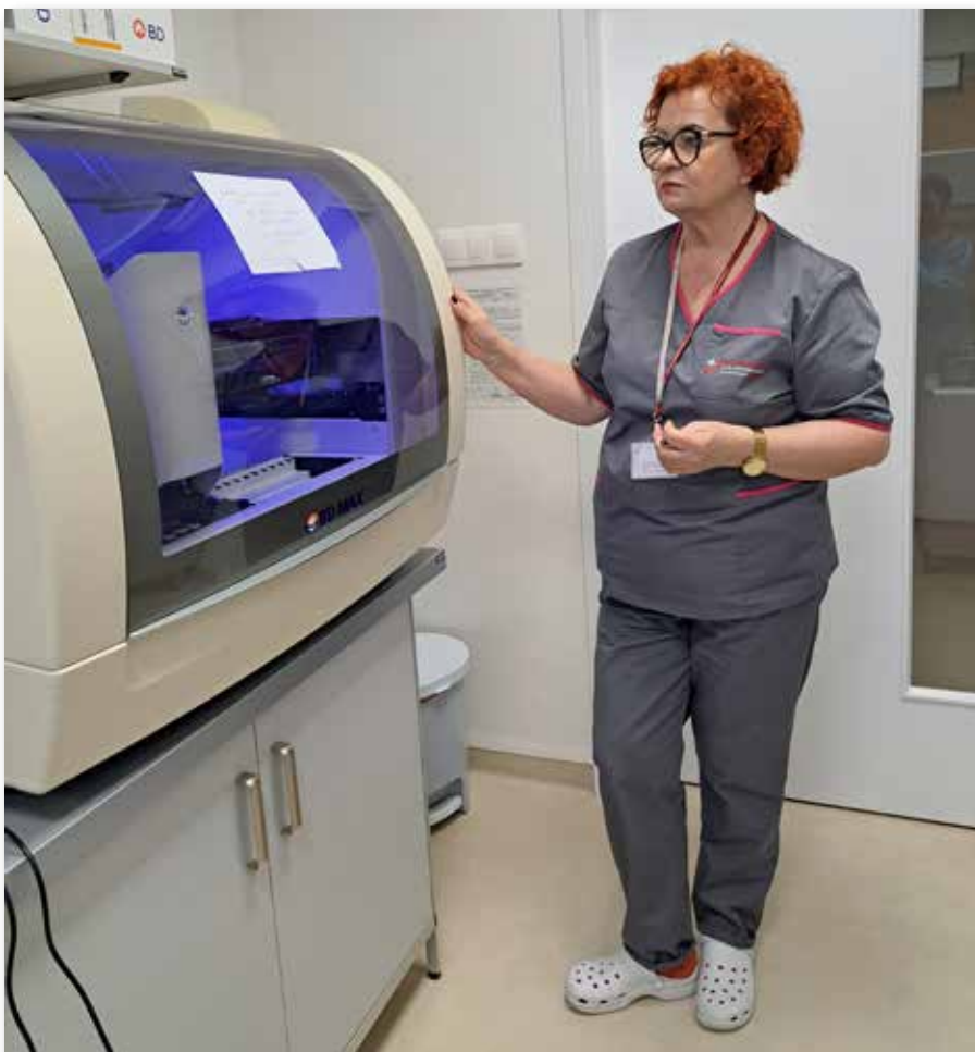
Prof. Eugenia Gospodarek-Komkowska przy aparacie BD MAX (Becton Dickinson) pozyskanym na początku pandemii SARS-CoV-2. To w pełni zintegrowana, zautomatyzowana platforma, która przeprowadza ekstrakcję kwasów nukleinowych i PCR w czasie rzeczywistym, dostarczając wyniki dla maksymalnie 24 próbek w czasie krótszym niż trzy godziny
