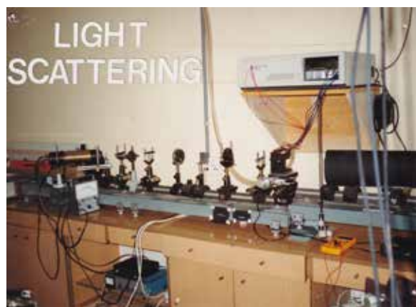
Zestaw doświadczalny do badania zjawisk rozpraszania światła w soczewkach ocznych zbudowany przez prof. B. Grzegorzewskiego
